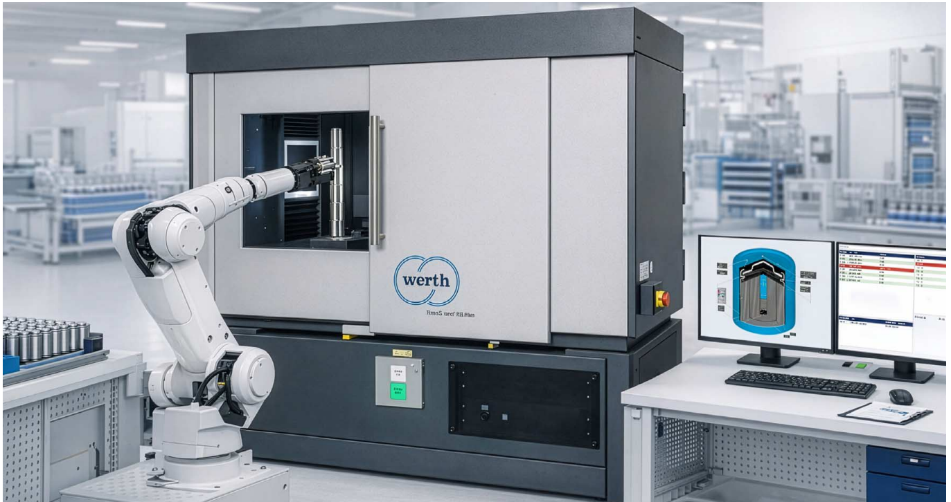
Bild 3 | TomoScope XS Plus 230 im Einsatz bei der fertigungsbegleitenden Messung von Batteriezellen
